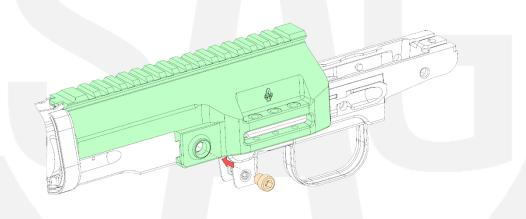
🗆 крон-крышка 🔁 установочный винт
