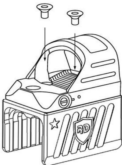
4. Установить конструкцию на пистолет, опустив её до характерного щелчка.
