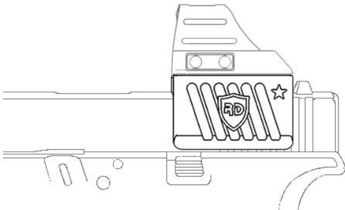
1. Снять прицел со штатного крепления, выкрутив болты.
