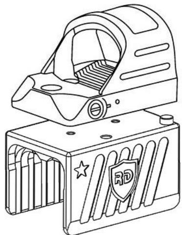
3. Закрепить прицел на кронштейне, используя короткие болты из оригинальной комплектации прицела.
